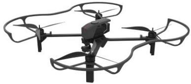
PabloS InspecX (자체개발, 항공기 외관검사)
